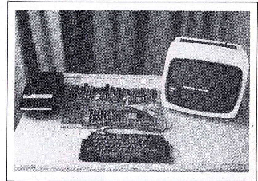
Un circuit imprimé de 42 x 27,5 cm supporte les quelques 88 circuits intégrés de « Micro-Systèmes 1 ».
